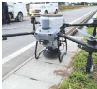
▲防除で活用するドローン
